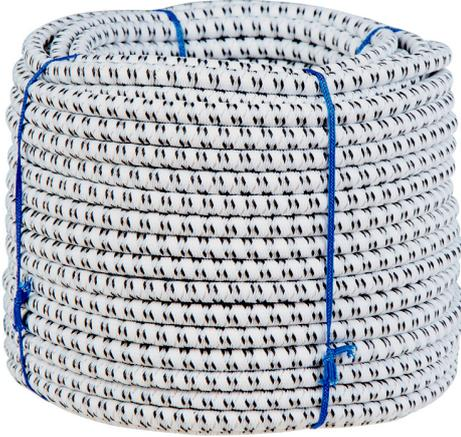
Abrivert vous propose ce **sandow** électrifié de 7 mm de diamètre, constitué d'une gaine en polyéthylène, résistante aux rayons UV, dans laquelle sont incorporés 3 fils inox de 0,20 mm pour faire passer le courant. Ce fil de couleur blanc moucheté noir, conditionné en couronne de 25 mètres, est d'une grande élasticité et d'une excellente visibilité pour le cheval.
