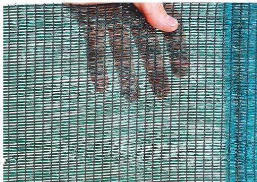
Lavable facilement à haute pression, ce filet brise-vent a une double structure textile superposant un réseau à mailles en monofils de PEHD avec un **tramage de bandelettes tissées**. Cette double structure subit un traitement thermique à haute température qui permet de bloquer le croisement des fils entre eux et d'assurer une parfaite stabilité dimensionnelle de l'écran. Abrivert conditionne ce filet brise-vent en rouleau de 50 m.
