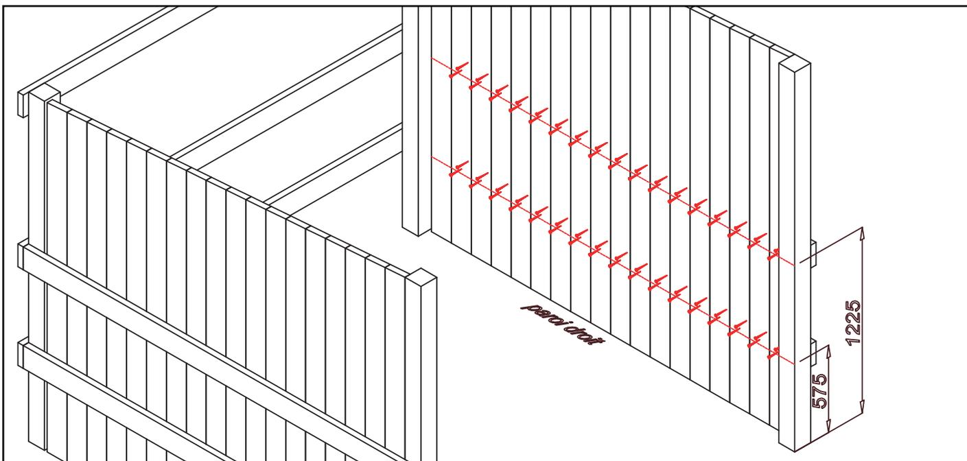
*4. Le long des planches de la paroi arrière (5) mesurer et marquer les lignes de hauteur des bastinges arrière (6) et fixer les planches à l'aide de vis 5x70 - 2 vis de chaque surface, fixées en croix, symétriquement des deux côtés de ces lignes.*
