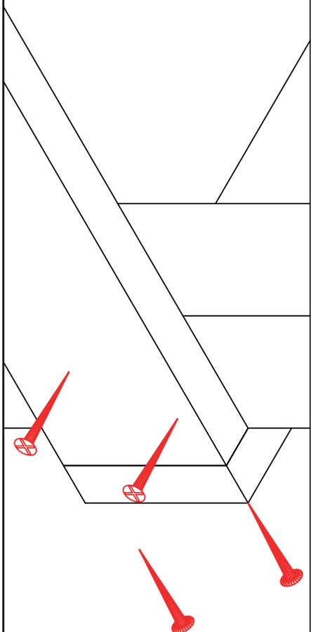
3. Positionner les planches de la paroi latérale accordément avec la numération. Mesurer le long des planches et marquer les lignes de hauteur des bastings (3) et fixer les planches dans l'ordre du numéro 4.1 - 4.18 à l'aide de vis 5x70 - 2 vis de chaque surface, fixées en croix, symétriquement des deux côtés de ces lignes.
