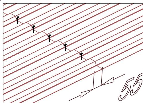
N'oubliez pas de mettre la partie arrière sous la partie avant après la mise en place de la partie avant du toit.
