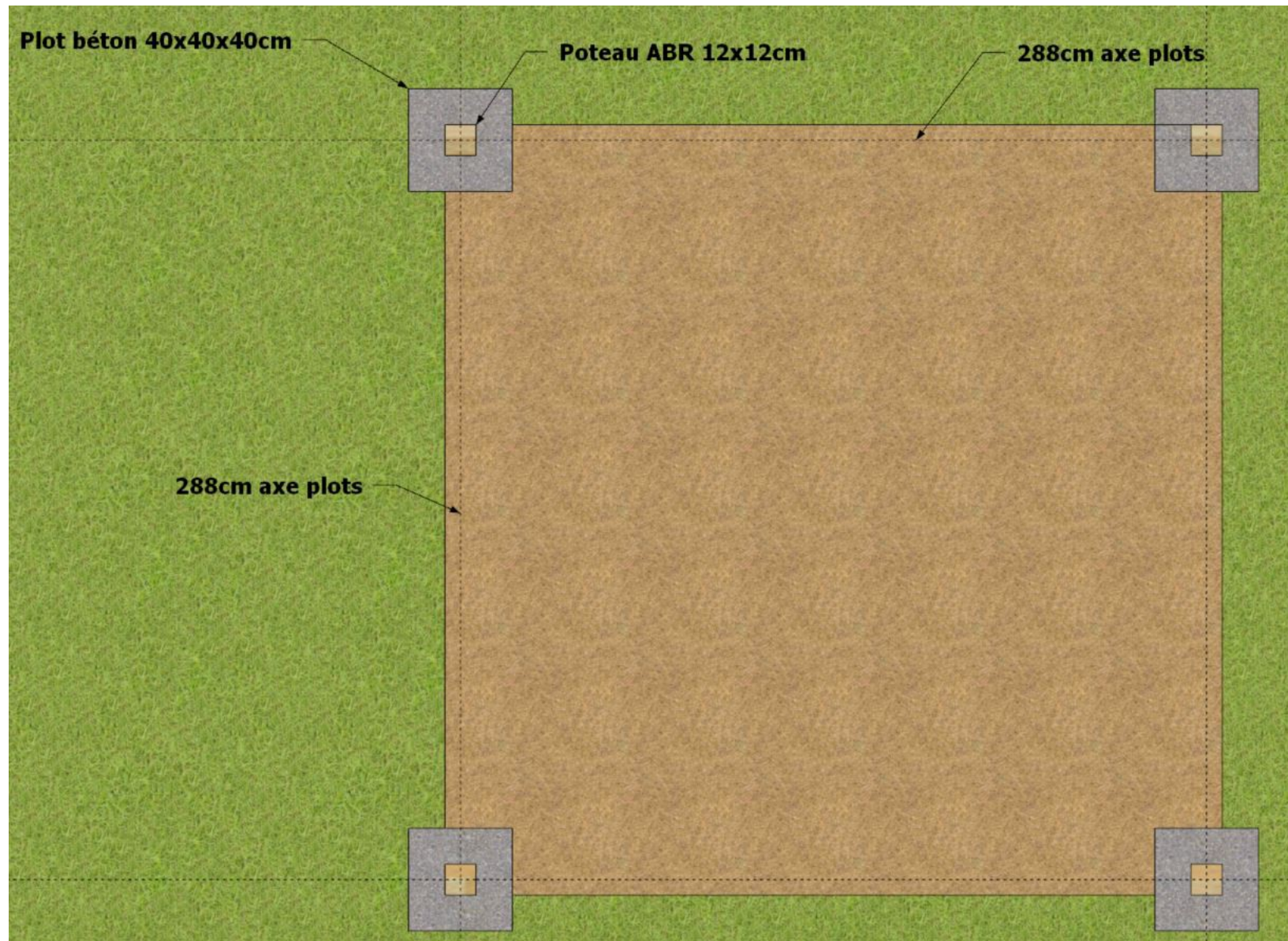
Position des blocs de bétons - Abrivert
