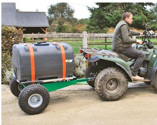
Le **châssis mécanosoudé** et peint de cette citerne roulante pour micro-tracteur ou quad améliore sa stabilité. Ce modèle de citerne, conçu en résine de polyéthylène a une contenance de 400 L. Il est équipé d'une flèche carrée de 2 mm d'épaisseur et dont chaque côté mesure 50 mm.
