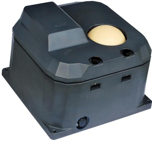
Cet abreuvoir pour chevaux est fabriqué en **résine de polyéthylène par rotomoulage**. Sa double paroi est remplie de mousse polyuréthane. Ce modèle 539, anti-gel jusqu'à -30 °C a une contenance de 40 L et mesure 68,30 cm de long sur 68,70 cm de large et 51 cm de profondeur.
